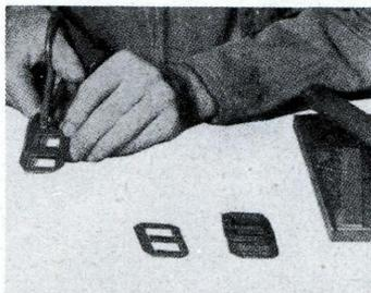
Un vecchio trasformatore di uscita per apparecchio radio fornisce il materiale per il nucleo magnetico. Ogni lamierino va tagliato in maniera da lasciarlo nella forma di una «E» maiuscola.
